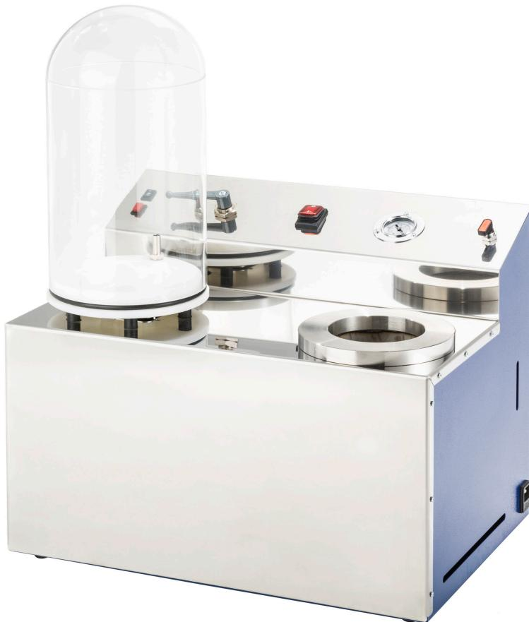
Impianto per la preparazione del rivestimento in gesso dei cilindri e la colata del metallo nel cilindro sottovuoto. E' costituito da una campana in plexiglass che attraverso la pompa del vuoto incorporata ne aspira l'aria. Un sistema di vibrazione a potenza sezionabile è disposto sotto il piatto di base. Ruotando la valvola deviatrice del sottovuoto si può procedere con l'utilizzo della camera di colata inserendo il cilindro con la sua guarnizione e attivando elettricamente la pompa del vuoto.
